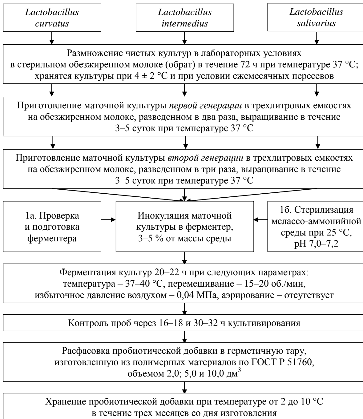
Рисунок 2 – Схема технологического процесса производства пробиотической добавки Галлобакт-Ф
